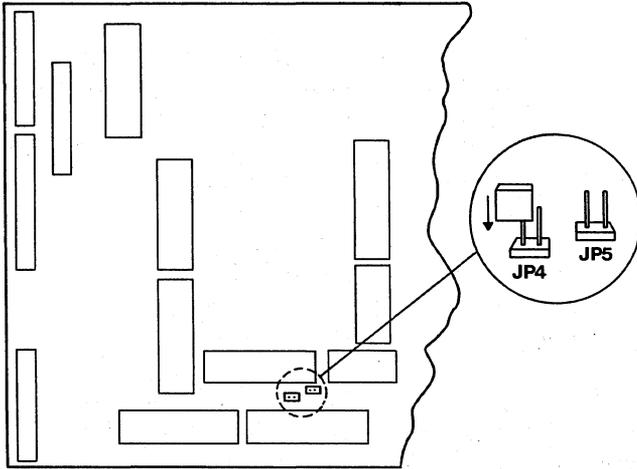
**JUMPER PINS ON CPU BOARD
