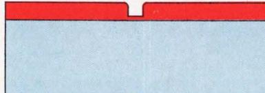
CAPACITOR PLATE IS ADDED TO CERAMIC
