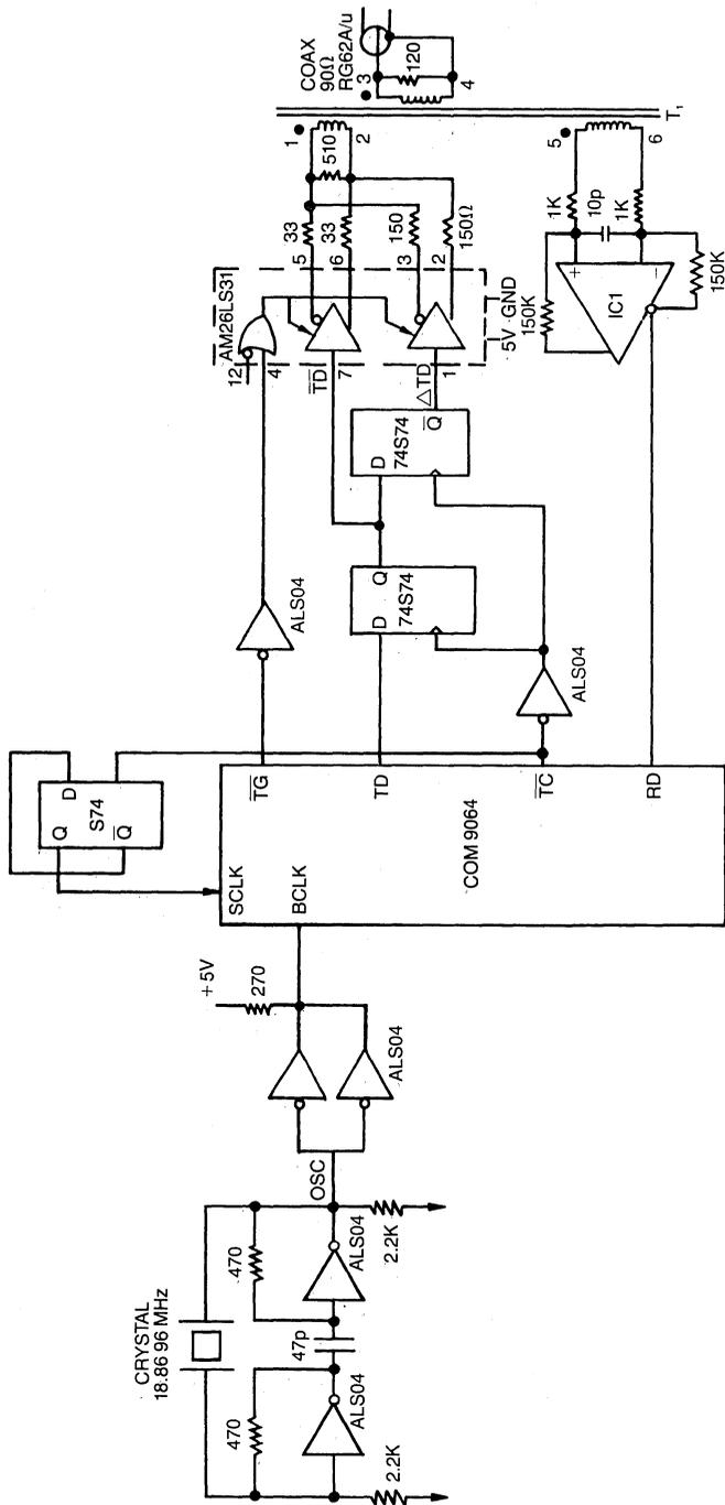
NOTE: 1. T1—1:1 PULSE TRANSFORMER (TECHNITROL PART NO. 11LHA, PULSE ENGINEERING P.N. 5762 OR EQUIV.)
