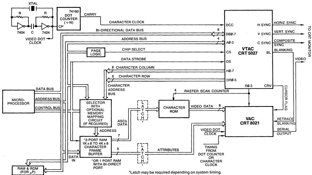
FIGURE 9. CRT 8021 TYPICAL  $\mu$ P CONFIGURATION (CHARACTER MODE ONLY)
