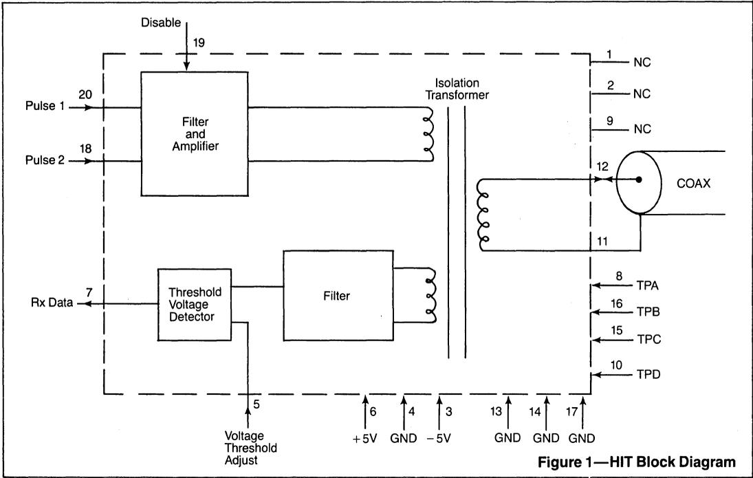
Figure 1—HIT Block Diagram
