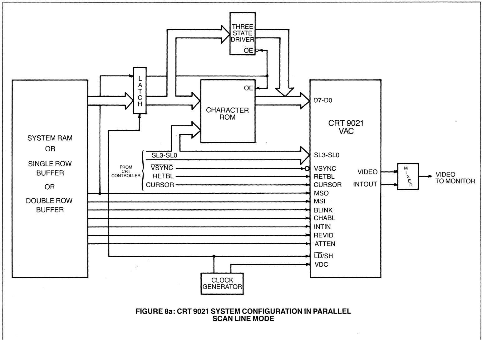
FIGURE 8a: CRT 9021 SYSTEM CONFIGURATION IN PARALLEL SCAN LINE MODE
