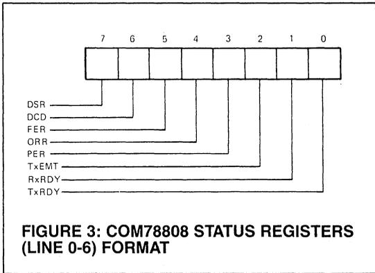
**FIGURE 3: COM78808 STATUS REGISTERS (LINE 0-6) FORMAT**
