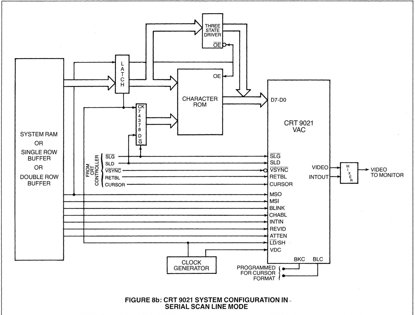
FIGURE 8b: CRT 9021 SYSTEM CONFIGURATION IN SERIAL SCAN LINE MODE
