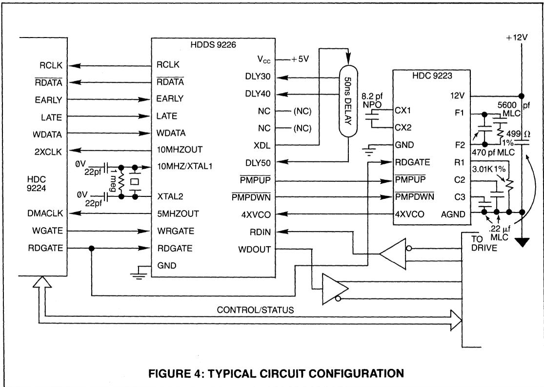
**FIGURE 4: TYPICAL CIRCUIT CONFIGURATION**
