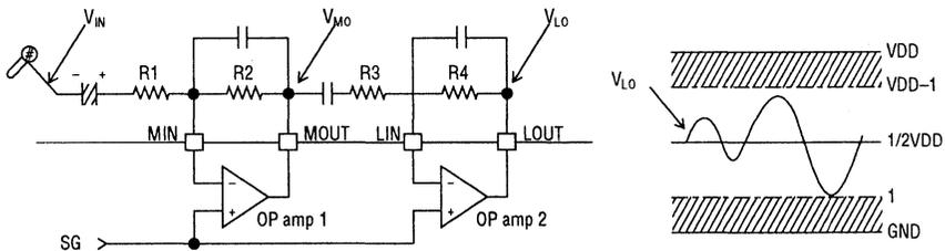
$$V_{LO} = \frac{R4}{R3} \quad V_{MO} = \frac{R2 \cdot R4}{R1 \cdot R3} V_{IN} \text{ (V)}$$
