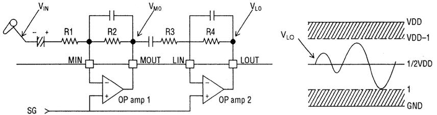
$$V_{LO} = \frac{R4}{R3} V_{M0} = \frac{R2 \cdot R4}{R1 \cdot R3} V_{IN}(V)$$
