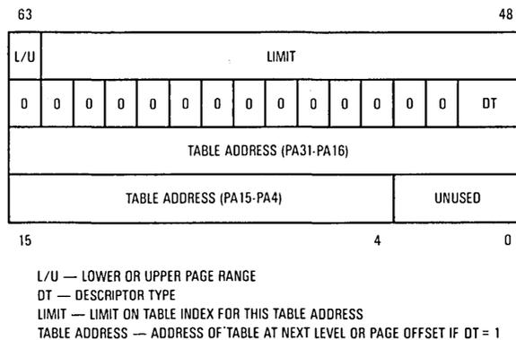
**Figure 9-9. Root Pointer Descriptor Format**
