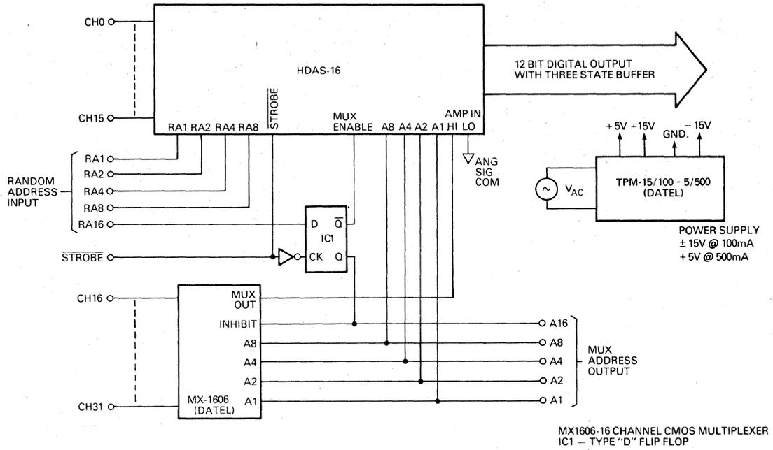
**FIG. 6 16 CHANNEL DIFFERENTIAL DATA ACQUISITION SYSTEM**
