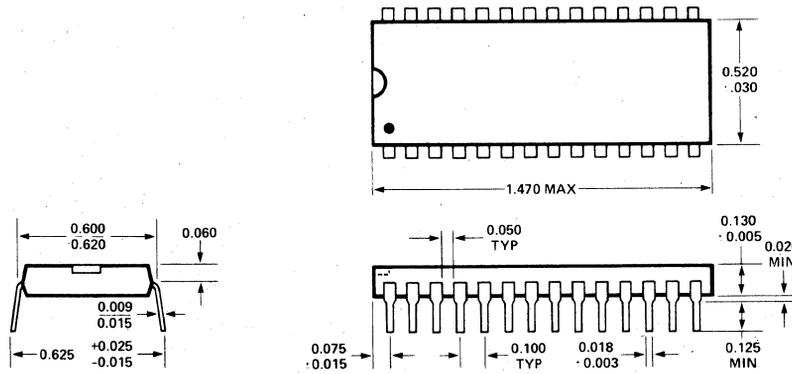
28 PIN PLASTIC DUAL IN LINE PACKAGE
