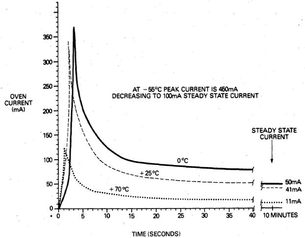
\*AT ZERO SECONDS POWER IS APPLIED TO THE MODULE AND THE OVEN SIMULTANEOUSLY
