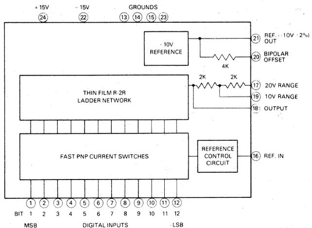
NOTE: FOR DAC-HF10B PINS 11 & 12 ARE NO CONNECTION
