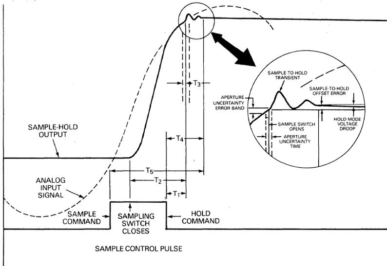
**T<sub>1</sub>. APERTURE DELAY TIME**
