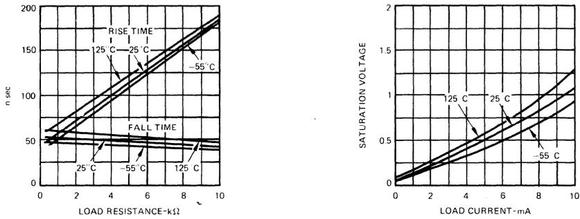
FIGURE 3. PERFORMANCE OF THE SQUARE-WAVE OUTPUT (PIN 9).
